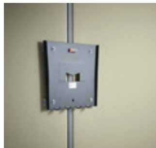
Monitorhalterung direkt in Systemprofil montiert
